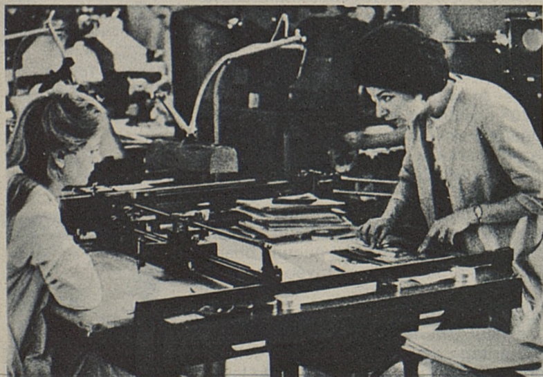
Toutes les informations photographiques rassemblées à Creil sont envoyées au service de photogrammétrie situé à Saint-Mandé près de Paris. Là, on traduit graphiquement l'image.
