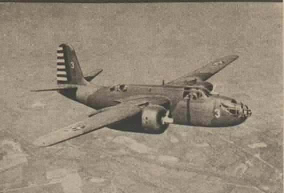
Le bombardier léger « Havoc » (« Dévastateur ») est un Douglas A-20 A, spécialisé dans les attaques à quelques mètres au-dessus du sol, contre les chars d'assaut, les batteries, les concentrations de troupes, etc. Il vole à plus de 560 km/h.
