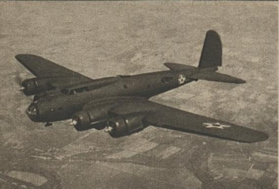
La « Forteresse volante » Boeing B-17, le plus fameux des bombardiers américains. Il pèse 22 tonnes, a un rayon d'action de 5000 km. et ne plafonne qu'au-dessus de 12 000 mètres. Son prototype fut essayé en 1935 déjà, puis ce géant connut de continuelles améliorations. Le type le plus récent a quatre moteurs Wright de 1500 CV, chacun.
