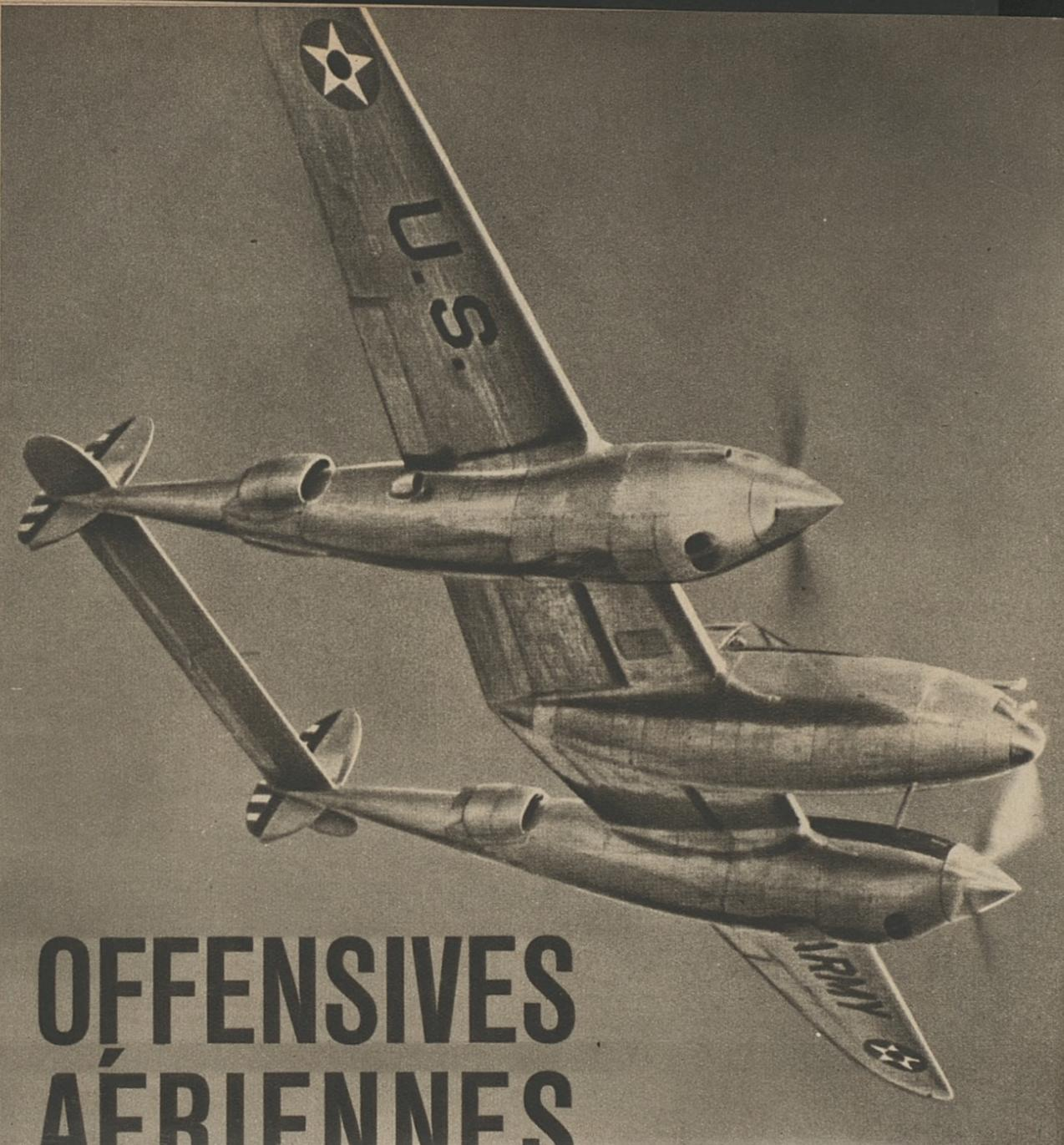
Le rapide « Lockheed-Lightning » (« Eclair ») P-38 dépasse les 650 km/h. Il peut s'élever de 1600 mètres à la minute. Quatre canons et quatre mitrailleuses sont placés dans le nez du fuselage. Il a deux moteurs de 1200 CV, chacun, une envergure de 17 m. et un atterrisseur tricycle. C'est un des rares monoplaces bimoteurs de l'heure présente.
