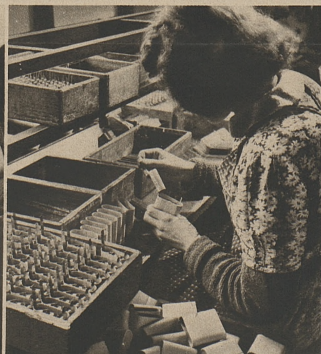
MONTAGE DES BATTERIES.
