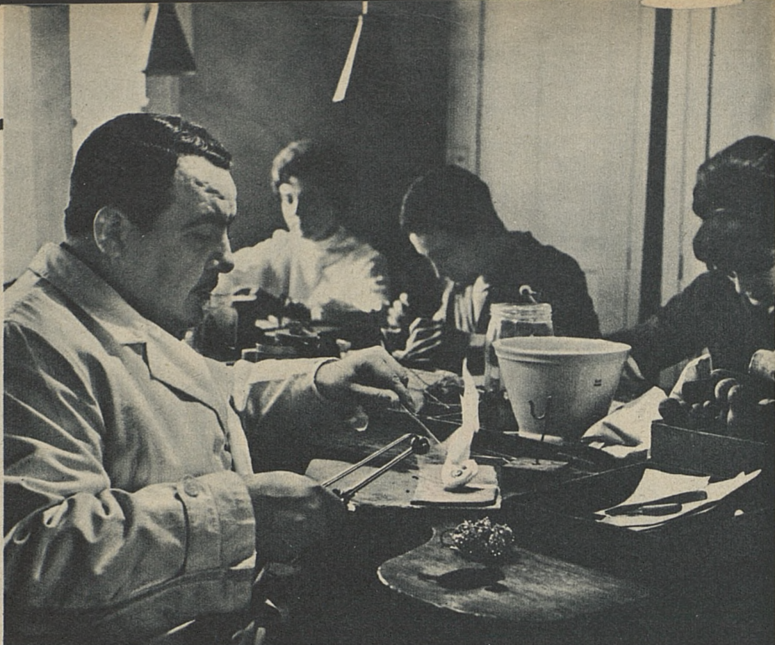
Au premier plan, à gauche, Roger Jean-Pierre est en train de remouler un modèle. Il travaille sur une flamme, des précelles (outil de spécialiste indiqué par Roger) à la main. Près de lui, un pot d'acide où il plongera la pièce pour la dérocher (sorte de polissage). Au fond, deux jeunes filles, un jeune homme souident les chatons dans lesquels s'enchaîneront les pierres.
